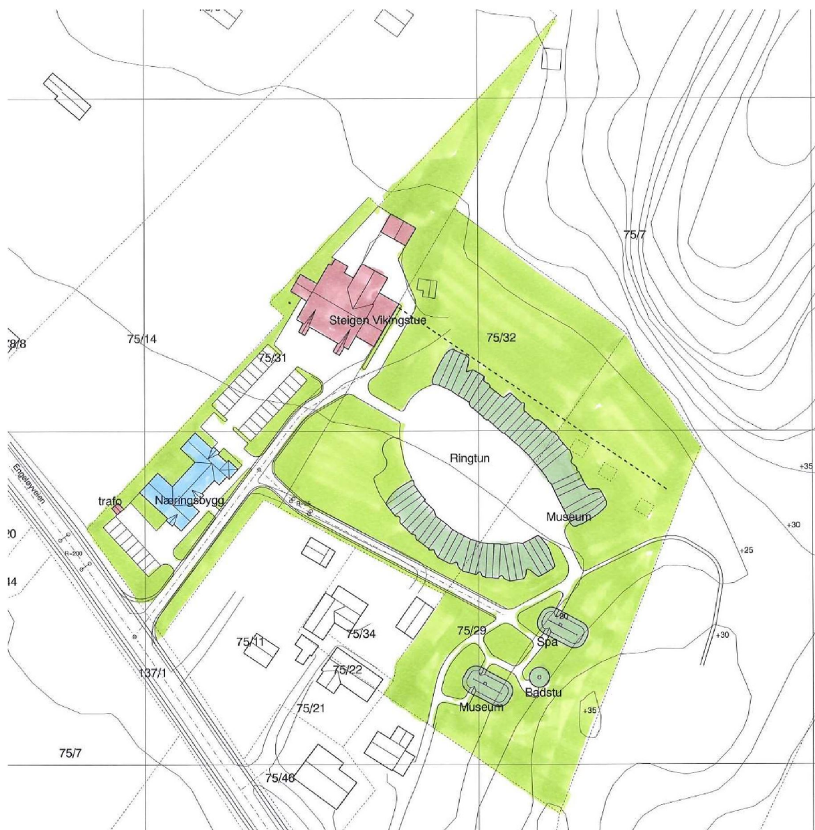
Figur 4. Situasjonsplan skisseprosjekt. Grense for rasområde (faresone) angitt med stiplert linje på oppsiden av ringtunet. Tegning BOARCH arkitekter a.s januar 2020.
